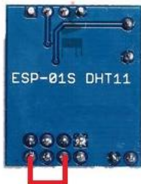
Dodatečná úprava zapojení (pin 4 a 8)
